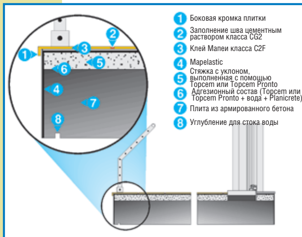
Фрагмент: гидроизоляция передней части балкона
